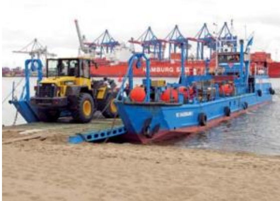
Abb. 11 Flachbodenschiff für Fahrzeug- und Materialtransporte
